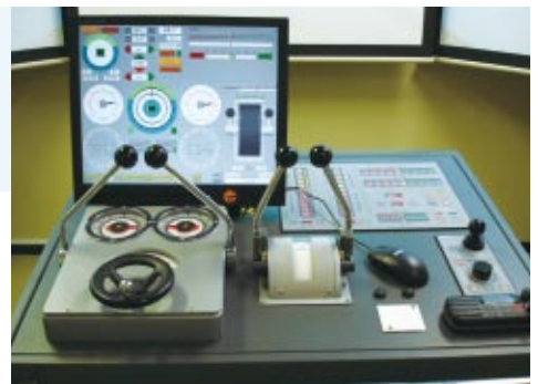
タグ操縦コンソール
